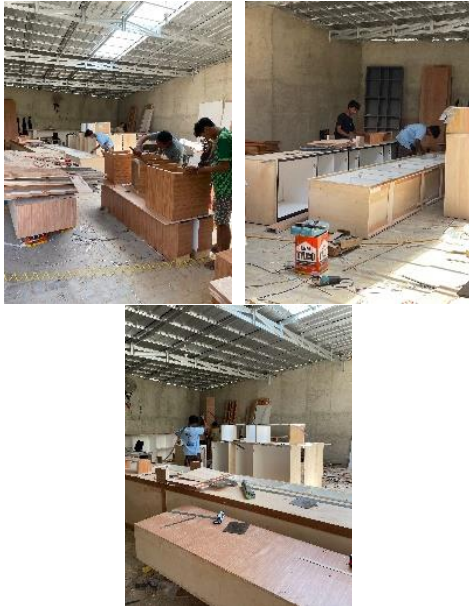
Gambar 5. Proses Pembuatan Furnitur dengan Finishing HPL (Sumber: Dokumen Penulis, 2024)
