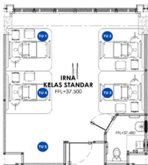
Gambar 4. Denah Titik Ukur IRNA 1 Gedung B Fasad Utara (sumber: Analisa Penulis,2024)
