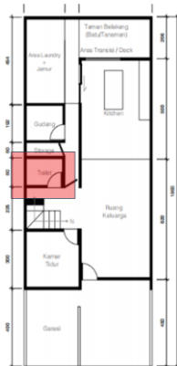
Gambar 8. Posisi toilet eksisting (Sumber: Dokumen Penulis, 2025)
