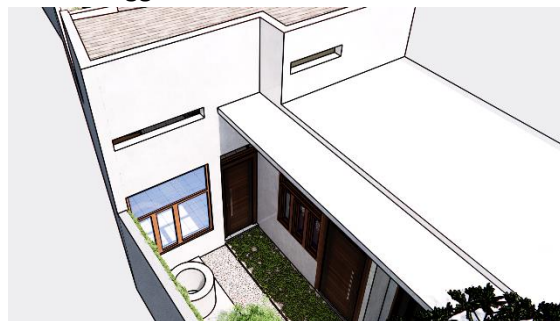
Gambar 15. Render 3D Fasad Area Belakang Denah Alternatif 1 Yang Mengimplementasikan Cross Ventilation Pada Desain Berbasis Sketchup.
