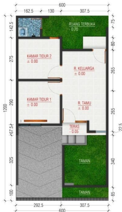
Gambar 3. Denah rumah tipe 36/72 TWP TNI AU (Sumber: WIN Property, 2025)
