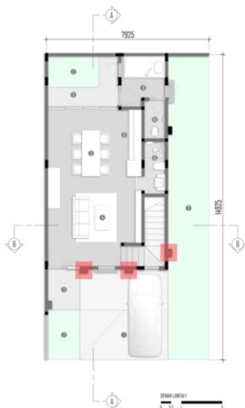
Gambar 9. Kolom Semu pada Perumahan Gedanganak Unit B (Sumber: Dokumen Penulis, 2025)
