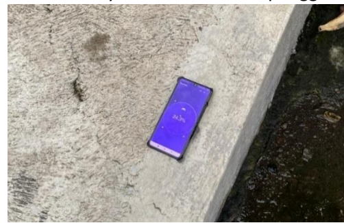
Gambar 12. Pengukuran kemiringan ramp (Sumber dokumen pribadi penulis, 2025)
