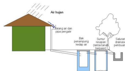
Gambar 8. Contoh skema sumur resapan (Sumber: Rockerz. 2009. Wordpress.)
