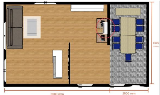
Gambar 7. Denah Eksisting AC. Sumber: Dokumen Penulis, (2025).
