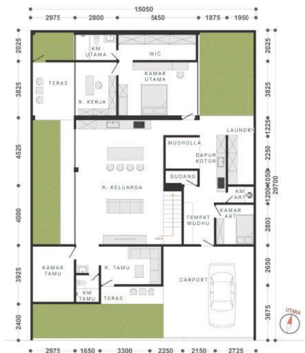
Gambar 1. Denah lantai 1 kondisi eksisting sebelum redesain
