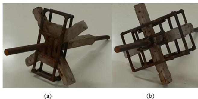
**Gambar 6.** Pembuatan blok beton dan rangka untuk uji kuat tarik,
