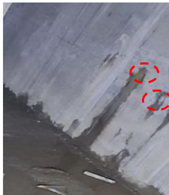
Gambar 4. Dinding Basah Setelah Tes Rendam
