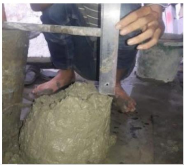
Gambar 2. Pengujian slump beton
