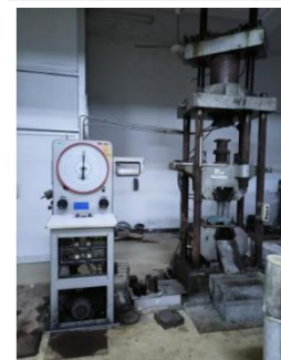
Gambar 3. Pengujian kuat-tekan beton
