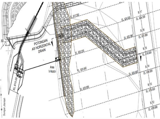
Gambar 2.1 Gambar potongan memanjang horizontal drain PT Virama Karya (Persero) Tbk (2022)
