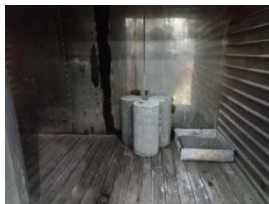
Gambar 12. Pengujian daya serap air beton
