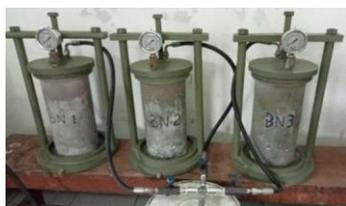
**Gambar 5. Pengujian permeabilitas beton**
