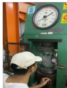
**Gambar 4. Pengujian modulus elastisitas**
