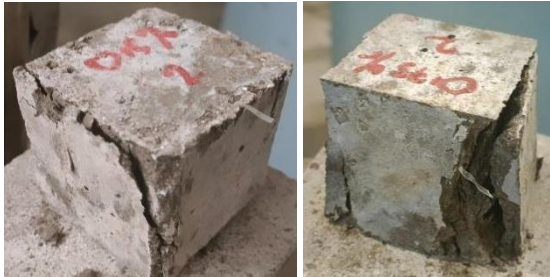
Gambar 3. Pola retak mortar geopolimer
