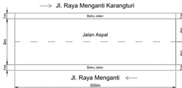
Gambar 2. Potongan memanjang jalan.
