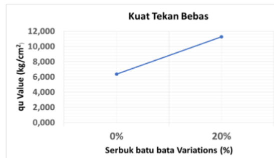
Gambar 2. Hasil pengujian kuat tekan bebas. (Gracella dkk., 2021)
