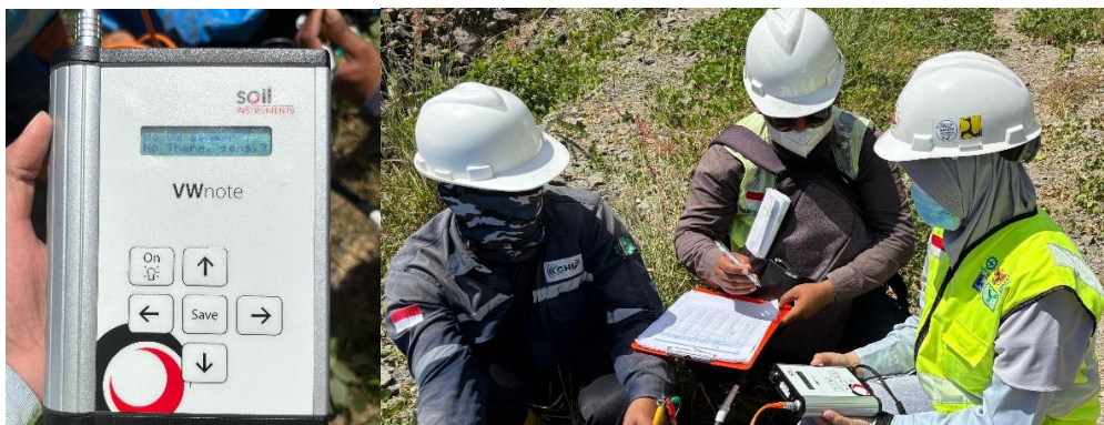
Gambar 8. Gambar pembacaan alat baca pisometer dan pengumpulan data hasil pembacaan. (sumber: data hasil lapangan)
