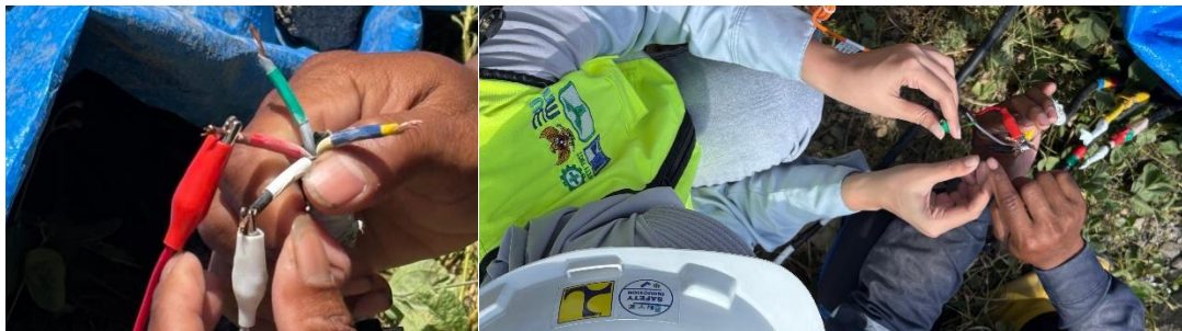
Gambar 7. Gambar pemasangan kawat getar dengan alat baca.
