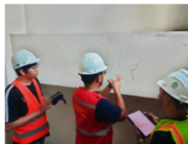
b). Proses Pengujian RH pada balok
