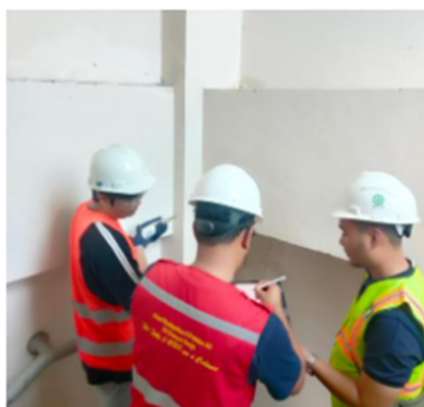
c) Proses Pengujian RH pada kolom
