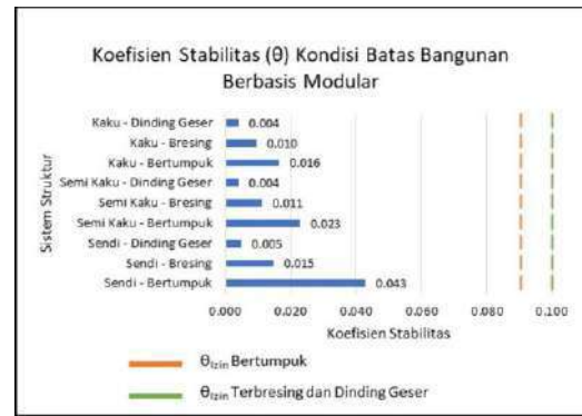
Gambar 4. Koefisien stabilitas struktur pada kondisi batas struktur (hasil analisis)
