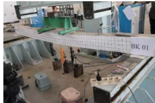
Gambar 3. Set-up benda uji balok bertulang
