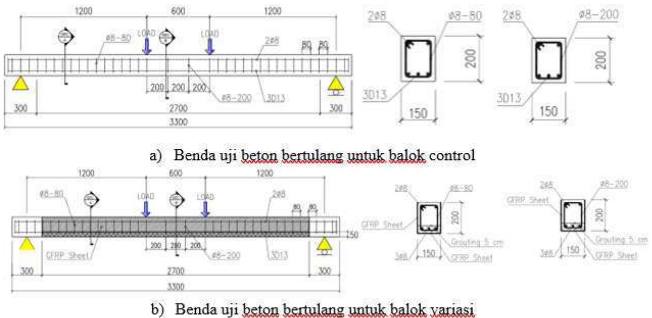
Gambar 1. Sketsa benda uji balok beton bertulang dengan perbaikan grouting dan perkuatan GFRP
