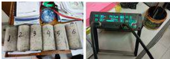
Gambar 5. Pengujian UPV beton silinder
