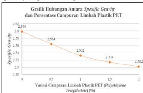
Gambar 2. Grafik Hubungan Specific Gravity dengan Presentase Penambahan limbah plastik PET ( Polyethylene Terephthalate )
