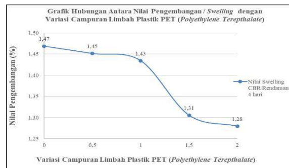
Gambar 7. Grafik Hubungan Nilai / Swelling dengan Limbah Plastik PET ( Polyethylene Terephthalate )
