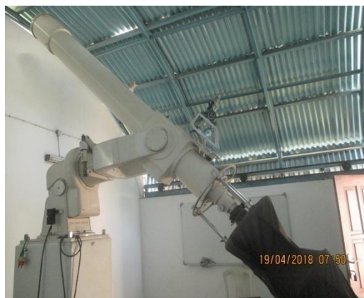
Gambar 3: Teleskop induk. Teleskop sunspot digunakan sebagai teleskop induk. Teleskop spektrograf planet Mars diletakkan di atas teleskop di dekat titik berat teleskop induk.
