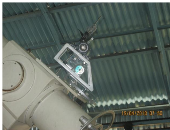
Gambar 4: Sistem gerak mandiri teleskop spektrograf planet Mars. Teleskop dapat bergerak arah utara-selatan dan barat-timur, masing-masing arah sebesar 5^{\circ} .
