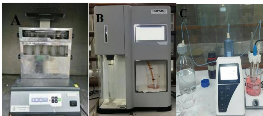
Gambar 2. Proses analisis protein. (A) Destruksi, (B) Destilasi, (C) Titrasi. Sumber: Dokumentasi pribadi.
